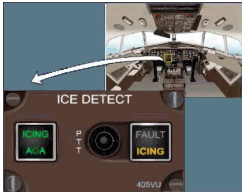
Figura 8 - Indicação do painel ICE DETECT com a luz âmbar ICING acesa, indicando condição de gelo. Fonte: ATR Training Centre.
