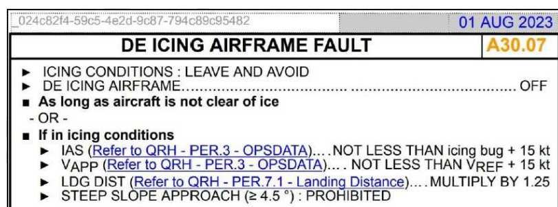
Figura 20 – Procedimento previsto para a falha do sistema De-Icing airframe previstos no QRH.
